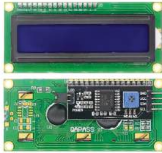
Gambar 9.22 Modul I2C yang dipasang pada LCD
